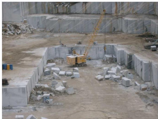
Рис.5.6 – Преимущество технологии проходки карьера с применением алмазно-канатных машин
