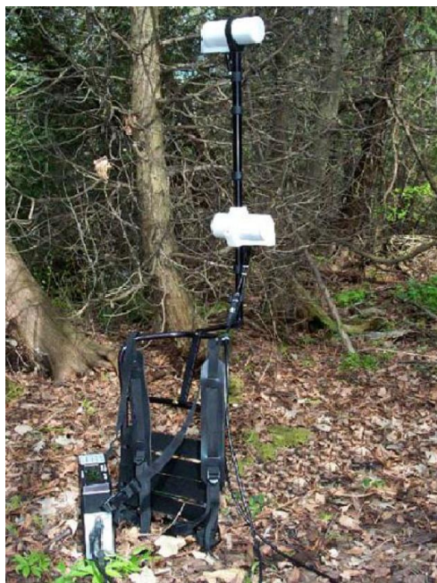
Рис. 5.11.1 Магнитометр GSM-19 в рабочем положении
