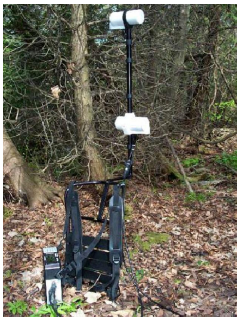
Рис. 5.11.1 Магнитометр GSM-19 в рабочем положении
