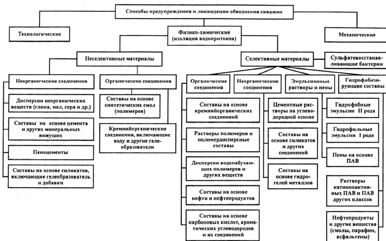
Рис. 9.1. Способы предупреждения и ликвидации обводнения скважин
