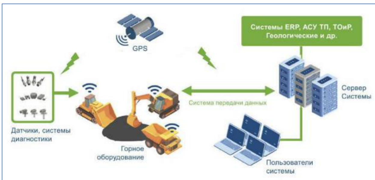
Рис. 8 – Типовая схема АСУ горными работами.
