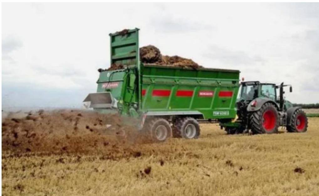
Рисунок – Разбрасывание навоза в качестве удобрения на полях универсальным прицепом-разбрасывателем TSW 6240S
