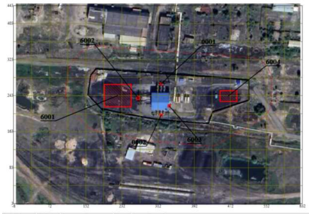
Рисунок 1. Ситуационная карта –схема с нанесенными на нее источниками выбросов в атмосферу на период эксплуатации объекта
