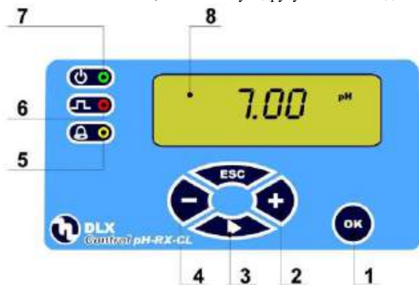
Рисунок 3. Панель управления насоса дозатора. Органы управления и индикации насоса-дозатора:
