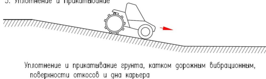
Рис.7.3.2 Принципиальная схема рекультивации грунтовых карьеров
