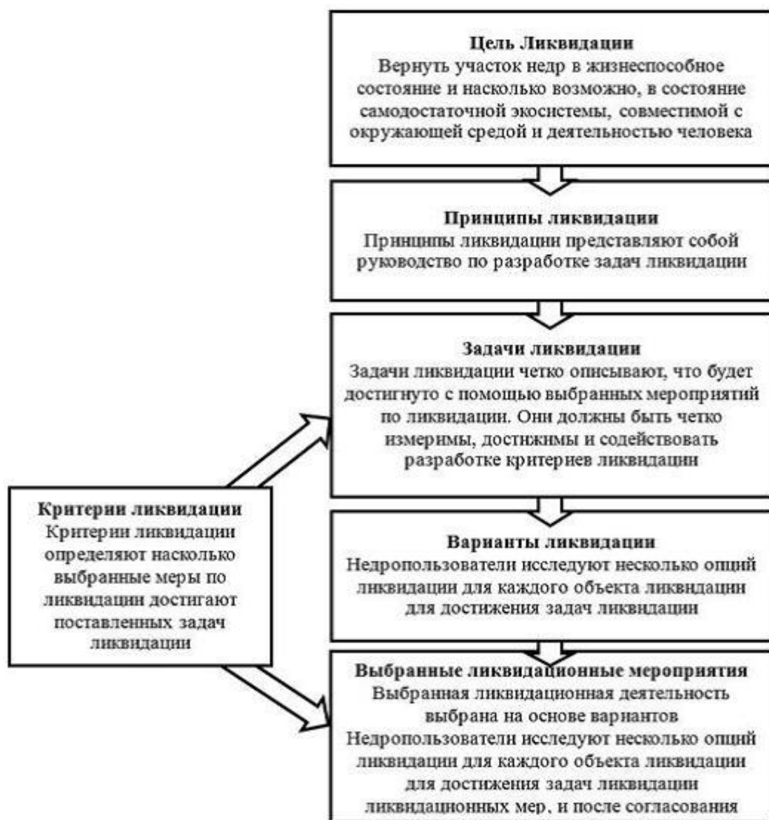
Рис.7.3.1 Схема планирования ликвидации
