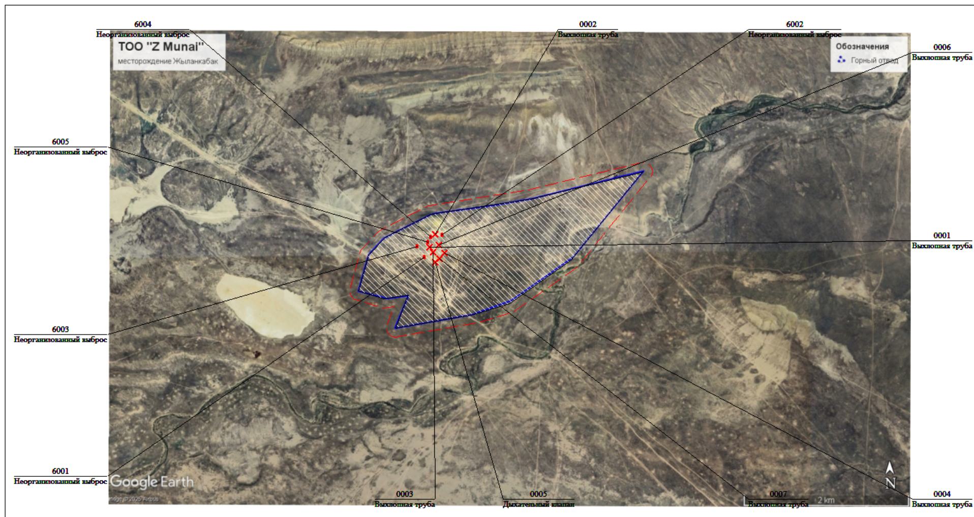
Рис. 4. – Карта схема расположения месторождения Жыланкабак с нанесенными источниками выбросов загрязняющих веществ
