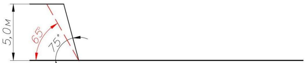
Погашение (выполаживание) бортов в ходе проведения добывчных работ с  $75^{\circ}$  до  $65^{\circ}$ .
