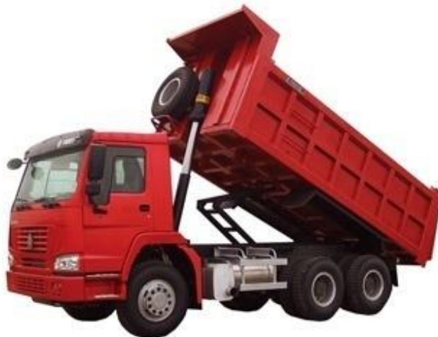
Рис. 2.15.1 - Самосвал HOWO 6x4 (340 л.с.), грузоподъемностью 25 тонн, кузов 5400x2300x1500 мм.
