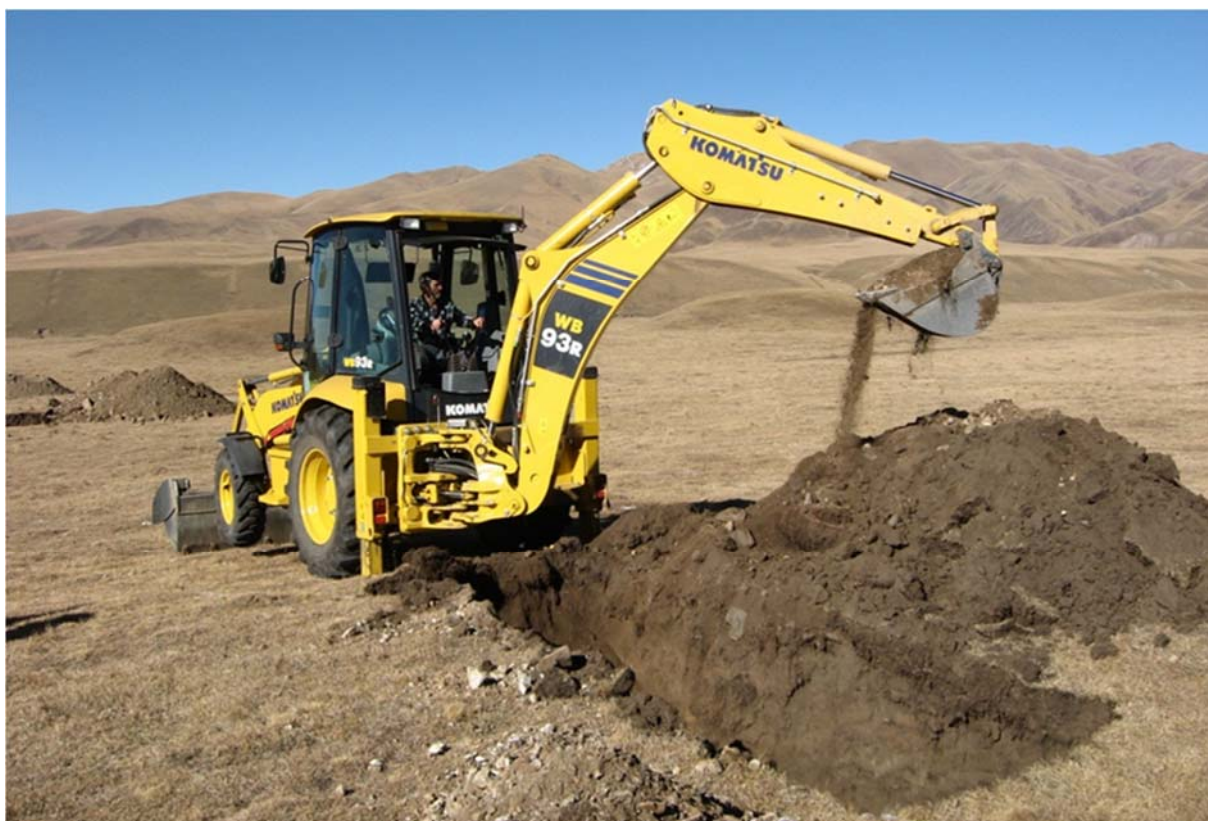
Рисунок 3.2 Внешний вид экскаватора KOMATSU WB93R-5EO
