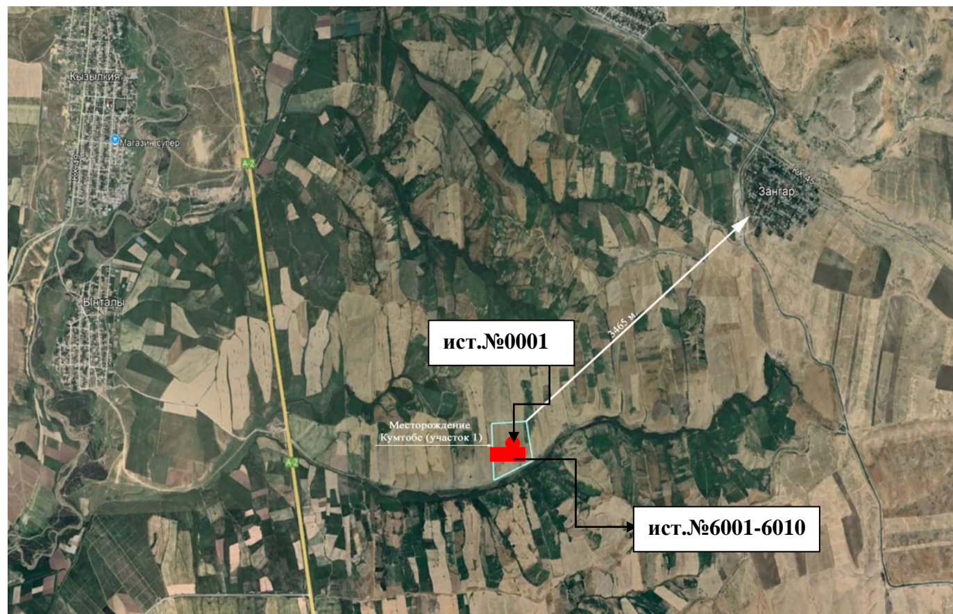
Рис.2. Карта-схема объекта с нанесенными на нее источниками выбросов загрязняющих веществ в атмосферу
