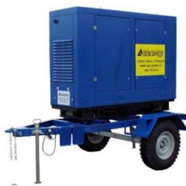
Рис. 7.2 - Передвижная дизельная электростанция типа ЭД-40-Т400-1РПМ11
