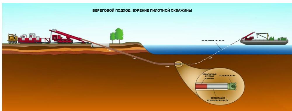
Первым шагом при выполнении ГНБ является бурение тщательно направляемой пилотной скважины, которая доставляет буровую головку на поверхность в указанной точке выхода. Бурение запускается с поверхности, от уреза воды, а пилотное отверстие движется вниз под углом до тех пор, пока не будет достигнута необходимая глубина.
