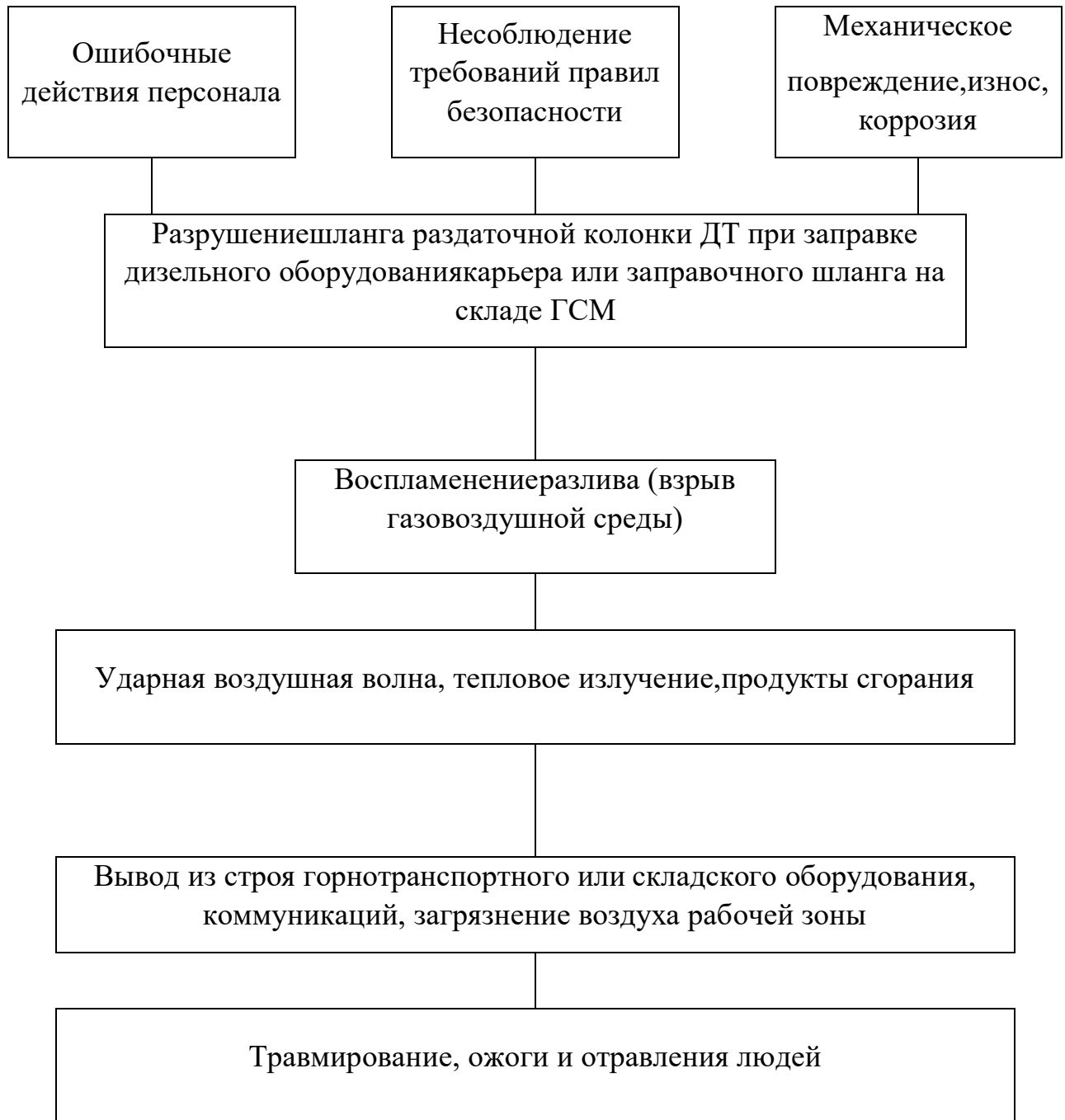
Рис.11.2- Блок-схема вероятного сценария возникновения и развития аварии при заправке дизельного технологического оборудования карьера из топливозаправщика или заправке емкости на складе ГСМ
