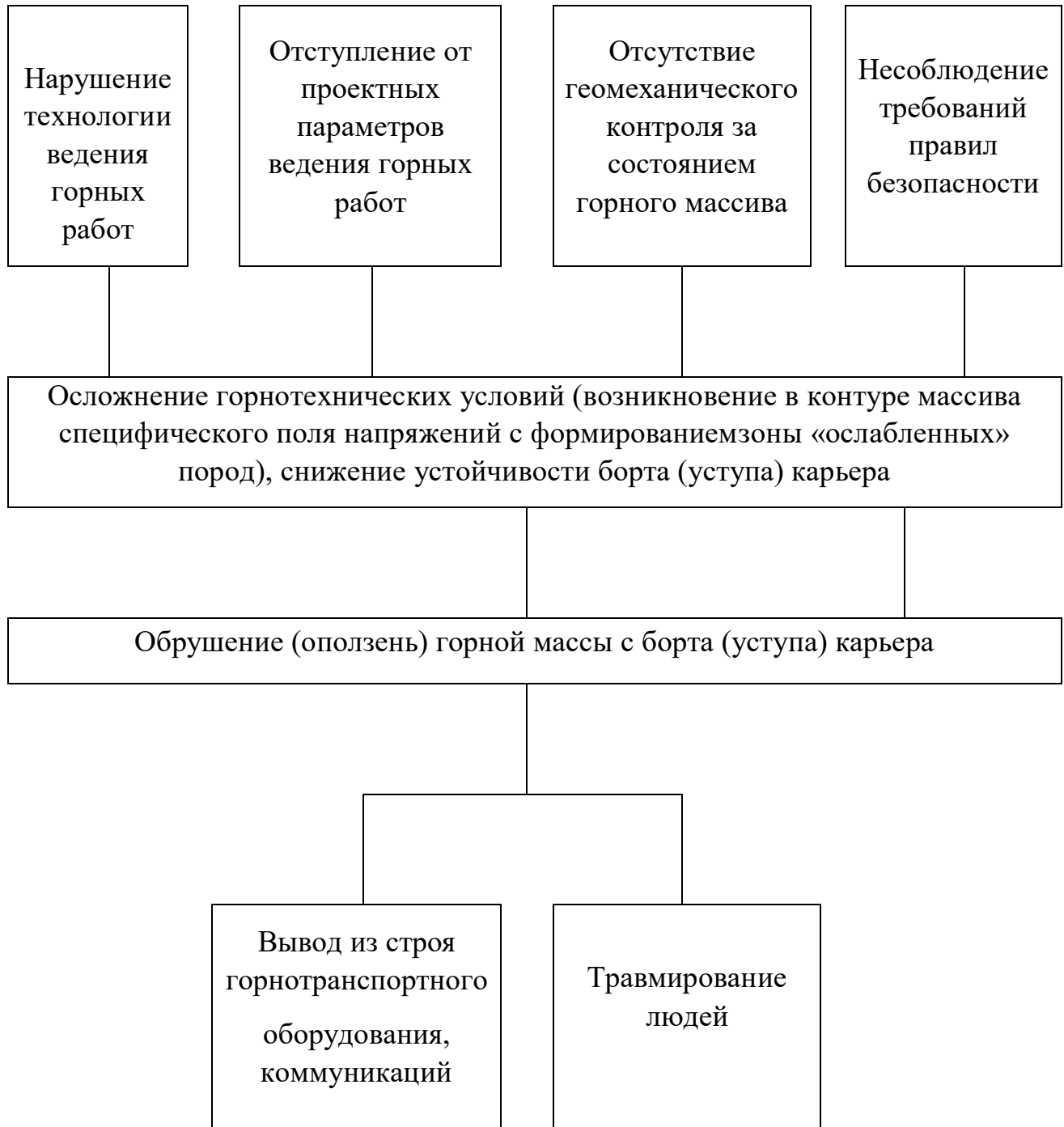
Рис.11.1 - Блок-схема вероятного сценария аварии при обрушении (оползней) горной массы с борта (уступа) карьера
