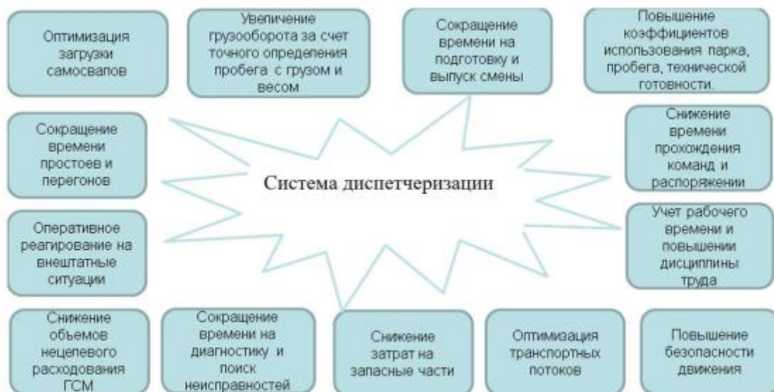
Рис. 8.1. Структура и функции системы диспетчеризации
