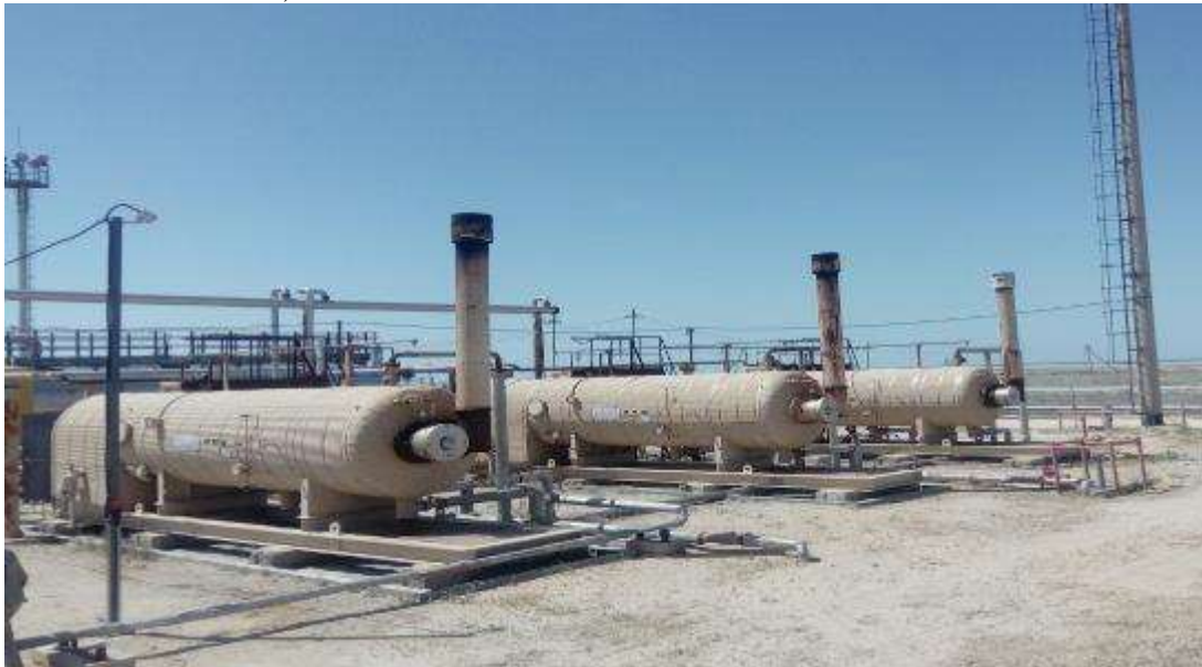
Рис. 2.1.2.2 Трехфазный тестовый сепаратор
