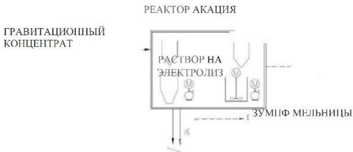
Рисунок 7.5 Схема цепи аппаратов переработки гравитационного концентрата.
