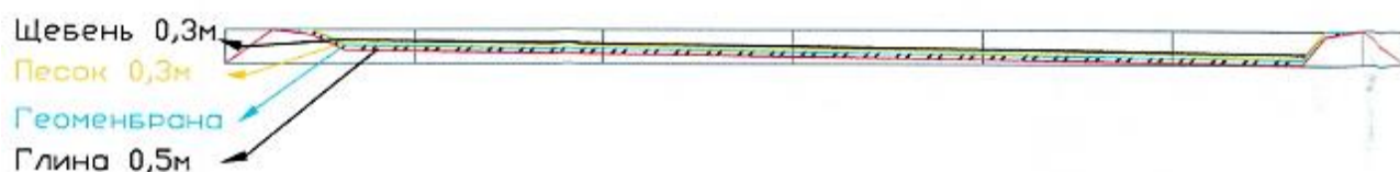
Рис. 2. Схема устройства основания площадки ПКВ
