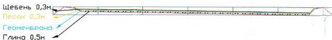
Рис.6. Схема устройства основания площадки ПКВ
