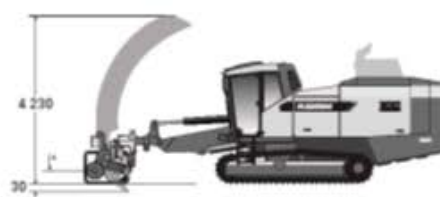
Охват при бурении подовенных скважин с коротким податчиком
