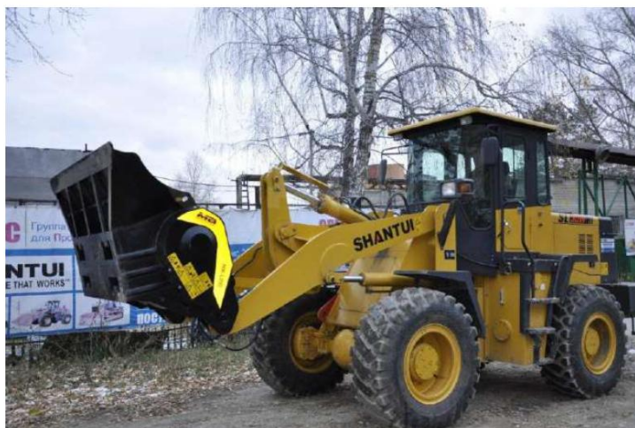
Рис.1.3 – Наглядный рисунок (фото) дробильного ковша установленного на фронтальный погрузчик
