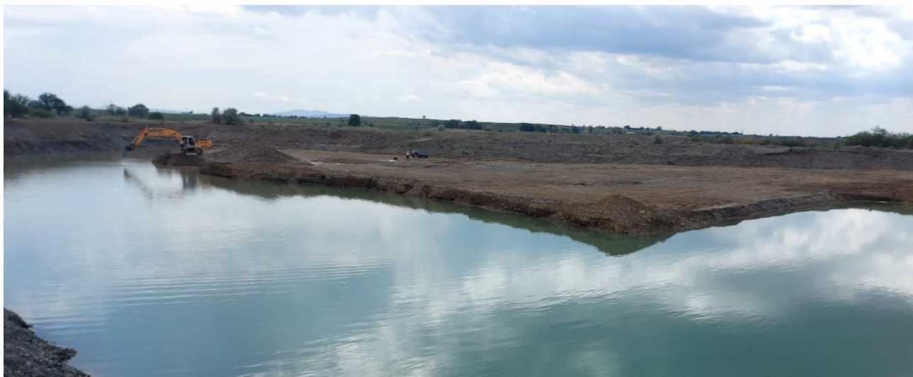
Рисунок 7. Добыча запасов по категории запасов C_2 . Добыча ведётся с подготовленной площадки дна карьера отработанных запасов по категории C_1
