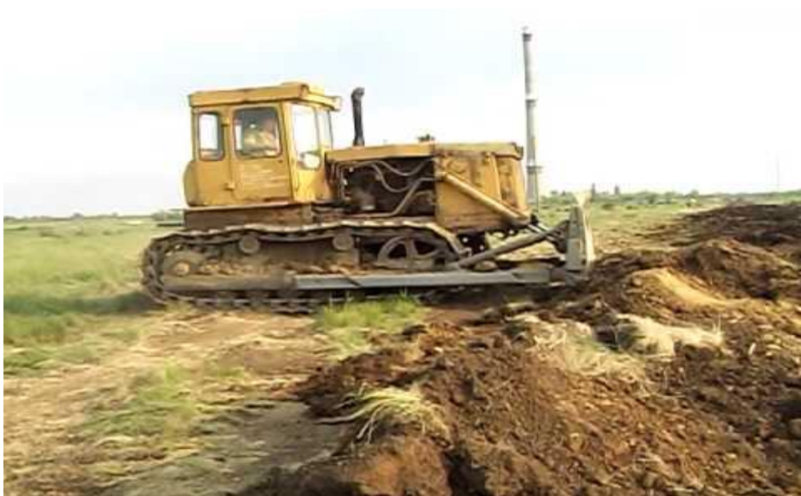
Рис. 15. Фото бульдозера Т-130, работающего по удалению вскрышных пород
