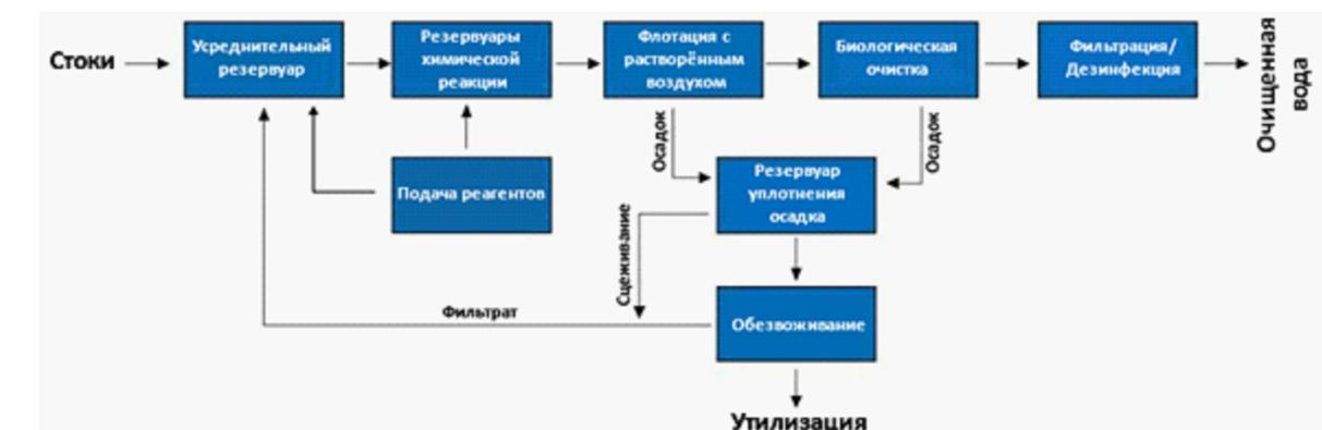
После процесса DAF (Dissolved Air Flotation) сточные воды по самотёку поступают в первичный отстойник (Primary Settling Tank, PST), где происходит удаление ила. Перелив из этого резервуара снова по самотёку поступает в приёмный резервуар (sump) для выравнивания состава стоков перед подачей их в первую биологическую аэротенку (Biological Aeration Tank 1).
