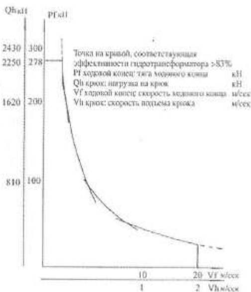
Рис.1. Подъемная характеристика буровой установки ZJ40J
