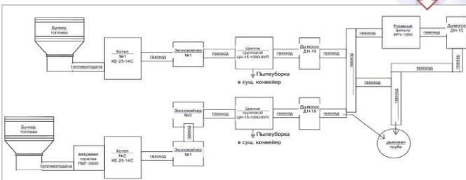
Котлы №1 и №2 оборудованы батарейными циклонами ЦБ-56. КПД на котле №1 – 92,5 %, на котле №2 – 93 %. Будет произведена замена на циклоны ЦН-15-1000-8УП. Дополнительно на котлоагрегатах №1 и №2 будет установлен один рукавный фильтр ФРУ-1500. Общая эффективность очистки дымовых газов для котельной составит 95%.
