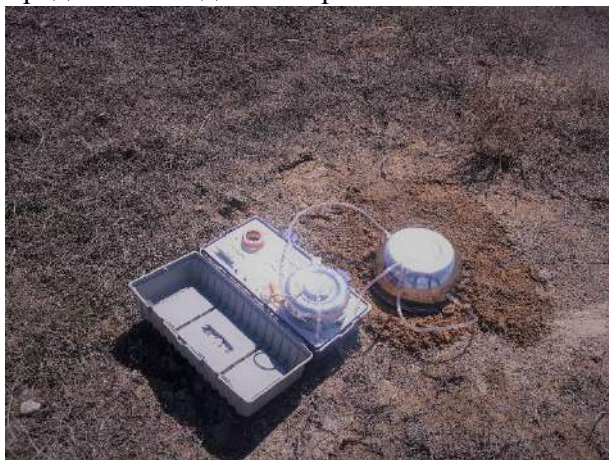
Рисунок 5.4.1. Измерение плотности потока Радона с поверхности почвы
