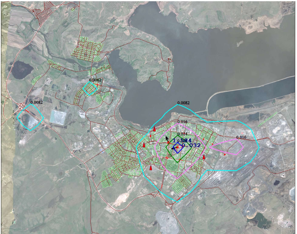
Рисунок 5.17 – Карта-схема рассеивания углерода с превышением ПДК в жилой зоне, формируемым выбросами автотранспорта на пересечении пр. Metallургов–ул. Абая
