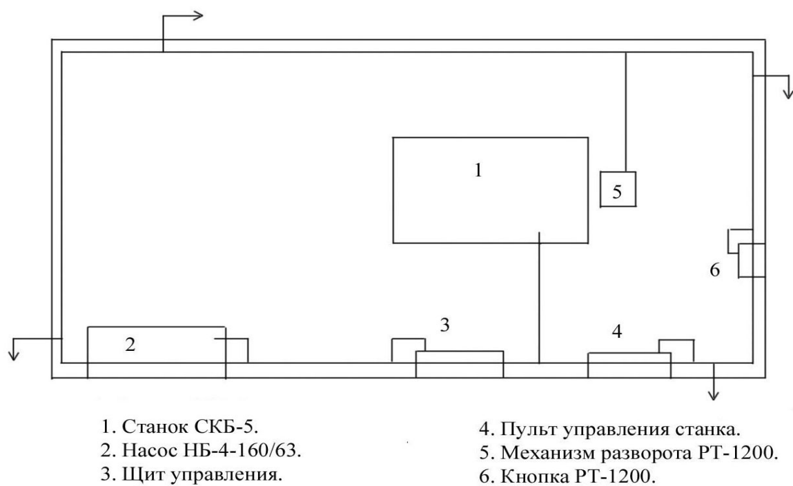
Рис. 5.8. Схема защитного заземления на буровом агрегате
