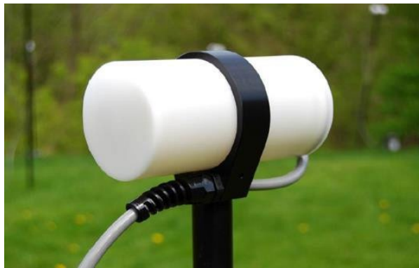
Рисунок 1.7.2. – Сенсор GSM-19 с обогащёнными свободными радикалами и приемник-регистратор GSM-19
