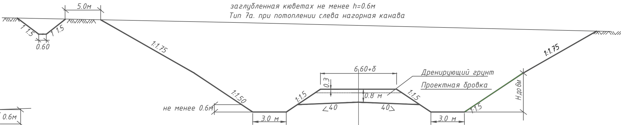
Тип 7. Выемка в обычных грунтах глубиной до 12м, разделяемая под насыпь (с заменой грунта на дренирующий)
