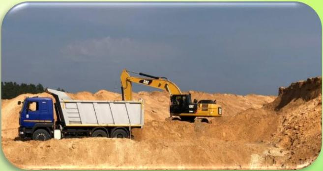
Құрылыс тасын (диабазы) өндіру – экскавация және тиеу (экскаватормен) - автокөлікпен тасымалдау - ұсақтау-сұрыптау кешеніне пайдалы қазбаны әкелу схемасы бойынша жүргізіледі. Бұл схема келесі дәйекті операцияларды орындауды қарастырады:
