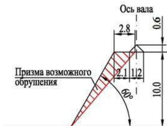
Рисунок 3.1 – Призма возможного обрушения
