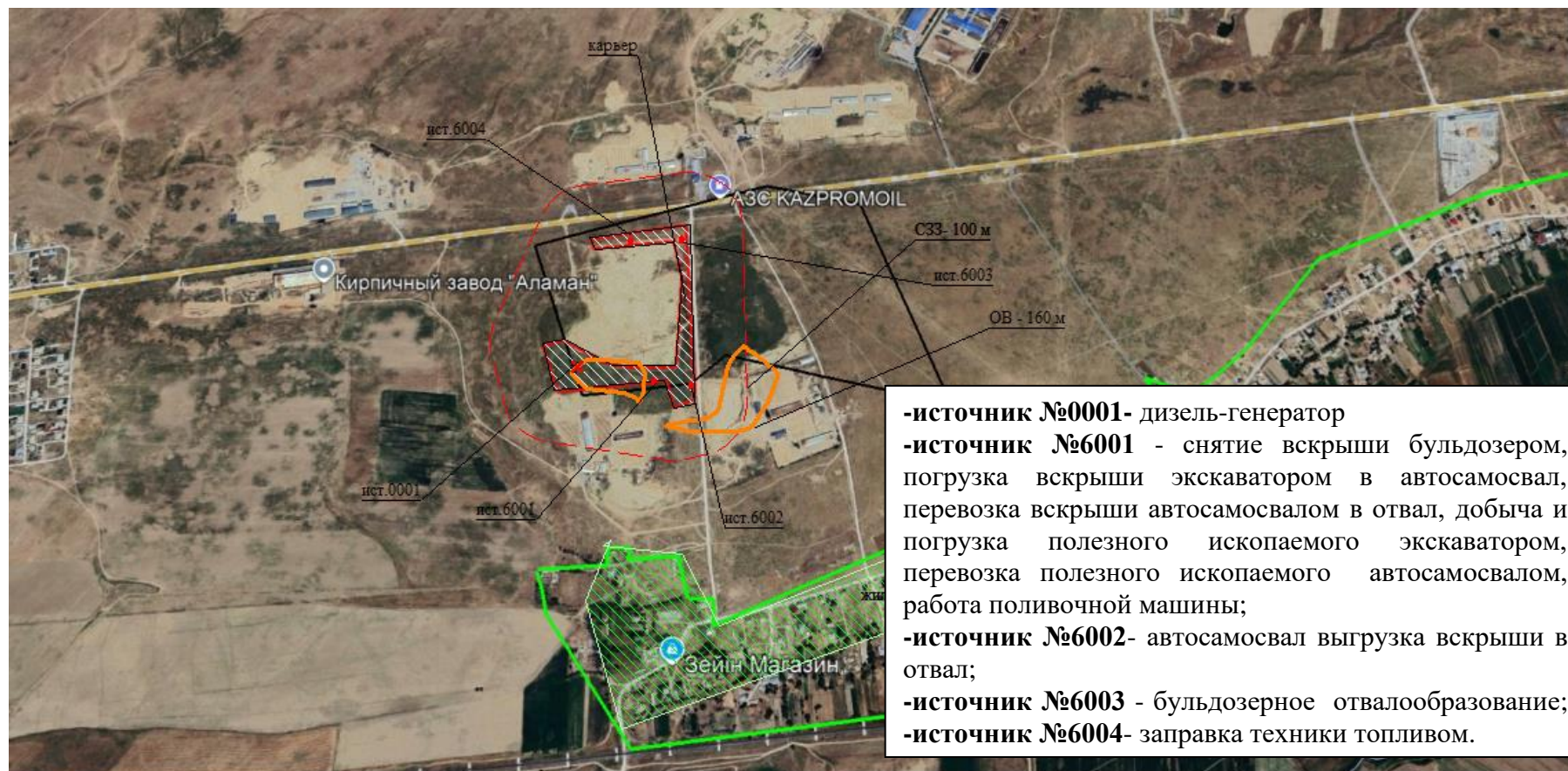
Рис.2. Карта-схема объекта с нанесенными на нее источниками выбросов загрязняющих веществ в атмосферу месторождения
