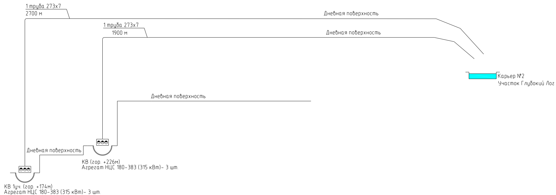
Рисунок 3.20 – Схема существующей системы водоотливных установок карьерного водоотлива месторождения «Бақырчик»
