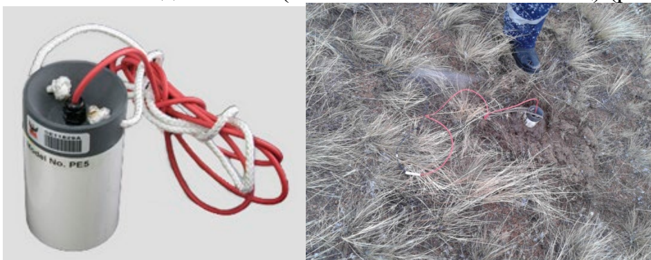
Рис. 5.13 - Неполяризующийся малошумящий электрод PE5
