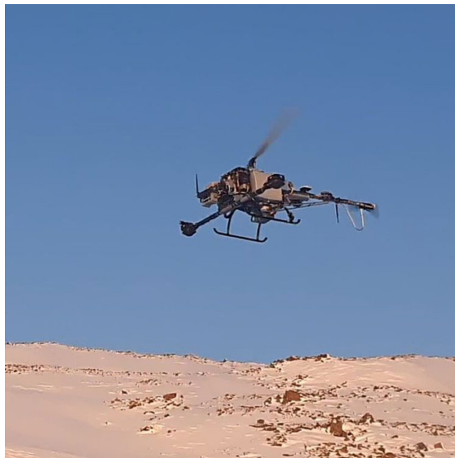
Рис. 5.14 Процесс аэромагнитной съемки
