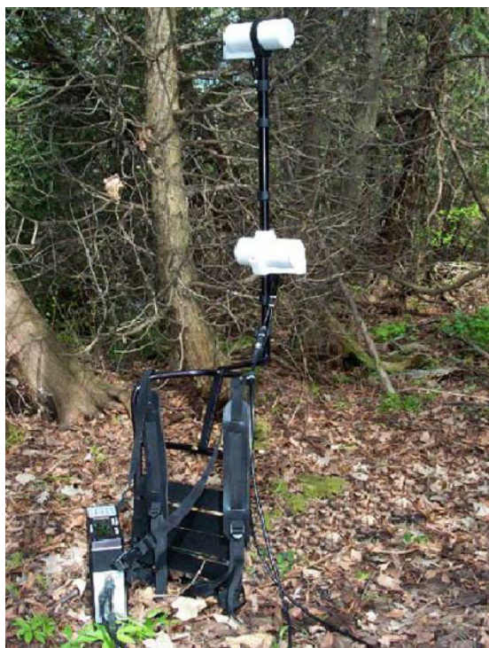
Рис. 5.3 Магнитометр GSM-19 в рабочем положении
