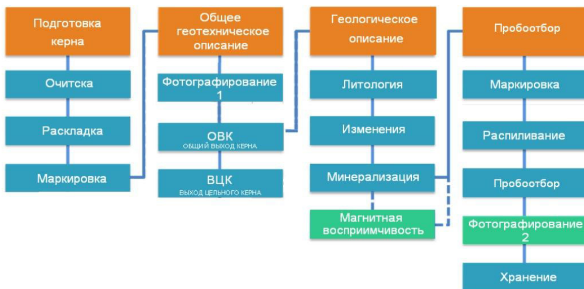
Рис. 4 Технологическая схема документации и обработки керна
