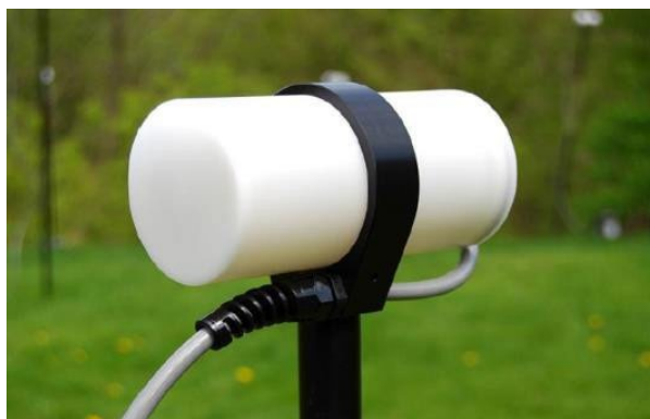
Рисунок 5.1 – Сенсор GSM-19 с обогащёнными свободными радикалами и приемник-регистратор GSM-
