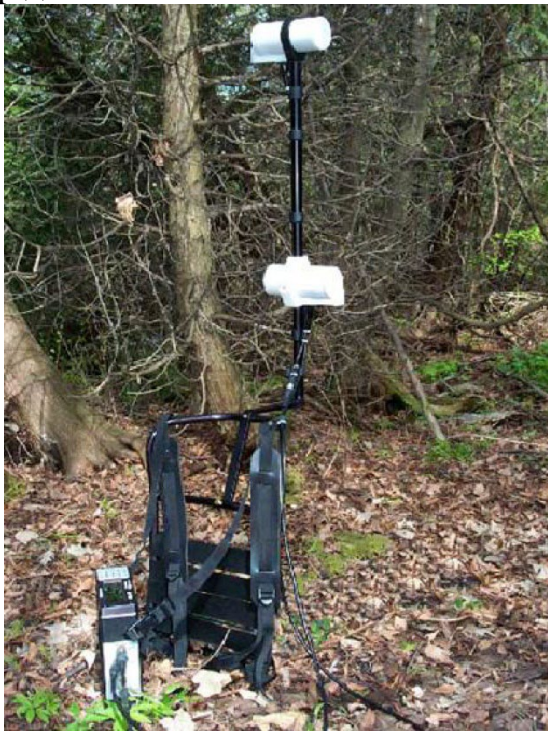
Рис. 5.3 Магнитометр GSM-19 в рабочем положении
