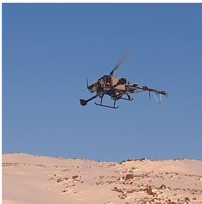
Рис. 5.14 Процесс аэромагнитной съемки
