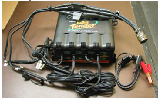
Рис. 5.11 - Блок батарей BTU-25/12 и BTU-45/12
