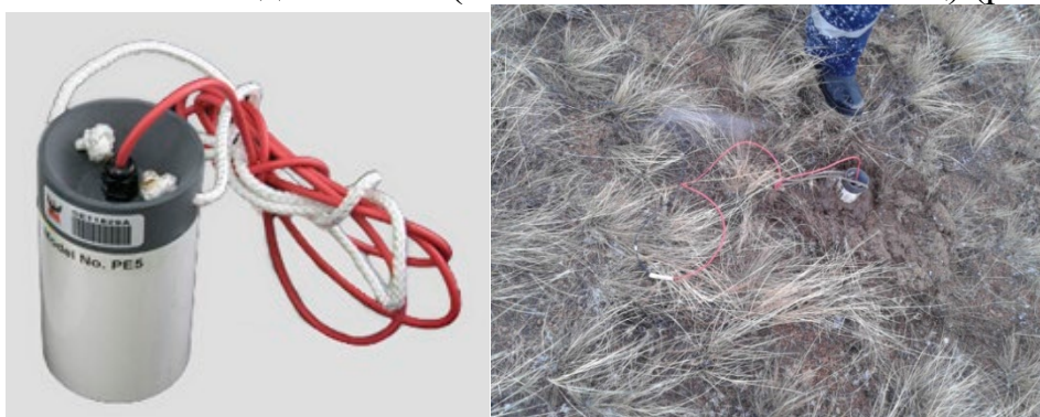
Рис. 5.13 - Неполяризующийся малошумящий электрод PE5
