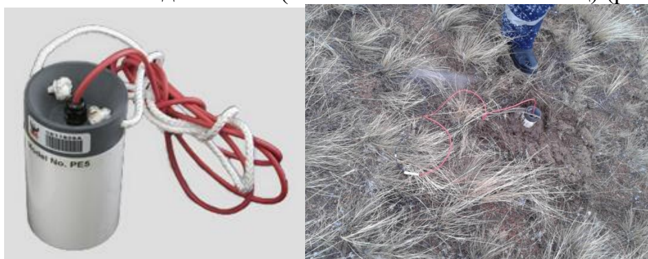
Рис. 5.13 - Неполяризующийся малошумящий электрод PE5
