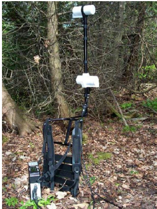
Рис. 5.3 Магнитометр GSM-19 в рабочем положении
