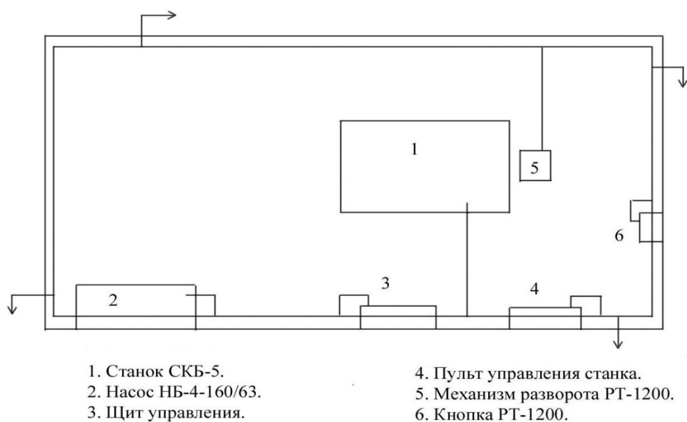
Рис. 1.6.8. Схема защитного заземления на буровом агрегате
