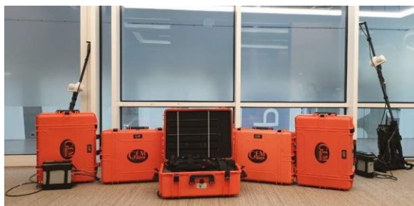
Рисунок 1.5.4 – Модульные магнитометры GSM-19W (Канада).
