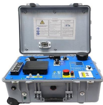
Рисунок 1.5.6. Электроразведочный передатчик GDD Tx4 Электроразведочные работы планируются проводить по сети 700 x 100
