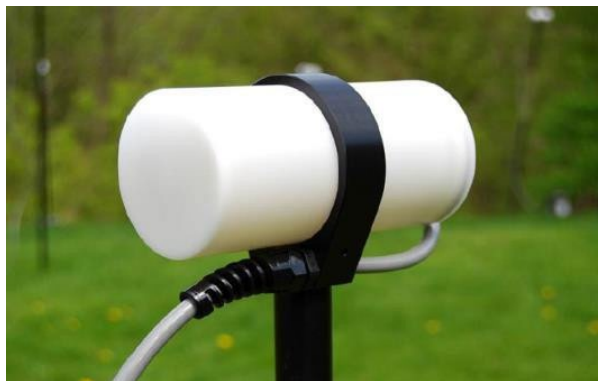
Рисунок 1.5.1 – Сенсор GSM-19 с обогащёнными свободными радикалами и приемник-регистратор GSM-19
