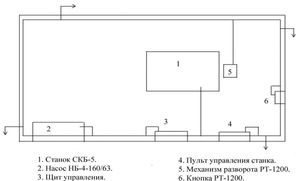
Рис. 1.6.8. Схема защитного заземления на буровом агрегате
