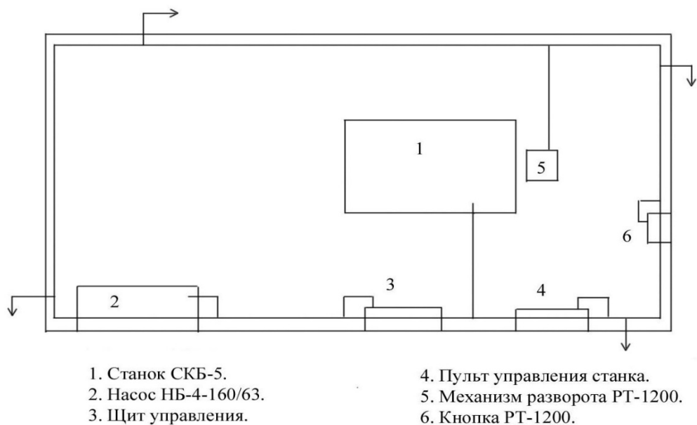
Рис. 1.6.8. Схема защитного заземления на буровом агрегате
