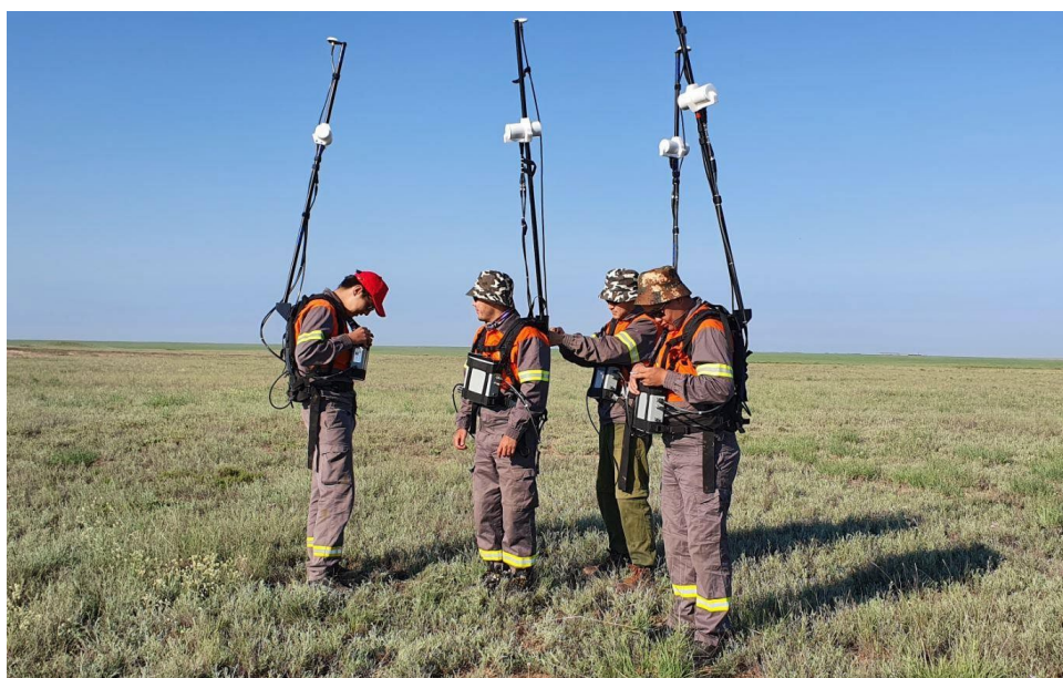
Рисунок 1.5.3 – Выполнение наземной магниторазведки с помощью модульного магнитометра GSM-19W (Канада)
