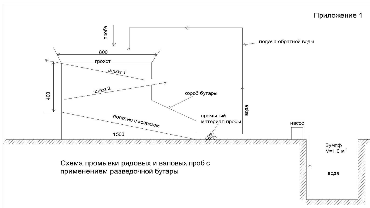
Рис. 2.2.1 Схема промывки рядовых и валовых проб с применением разведочной бутары
