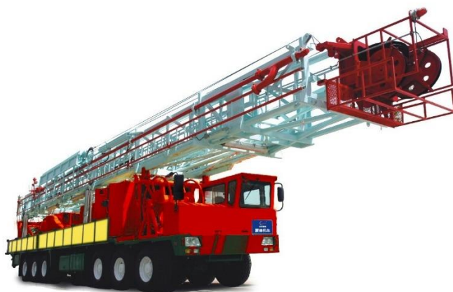
Рис. 1.4. Самоходная буровая установка типа XJ-450 или УПА -60/80.
