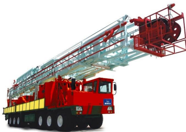
Рисунок 1.3. Самоходная буровая установка типа XJ-450 или УПА -60/80.
