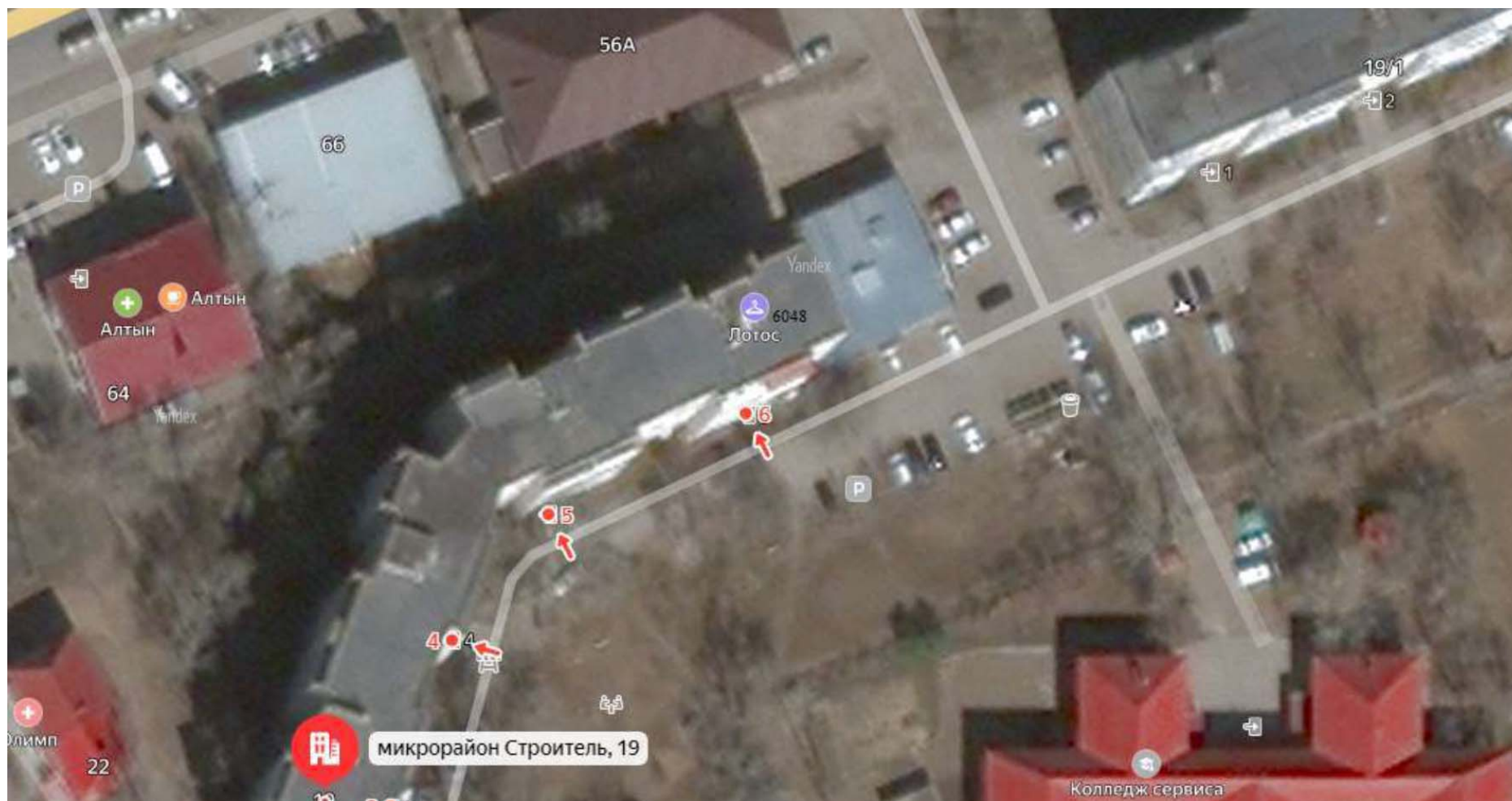
Рисунок 9 - Карта-схема Комплекса бытового обслуживания «Лотос» с нанесенными источниками выбросов загрязняющих веществ в атмосферу
