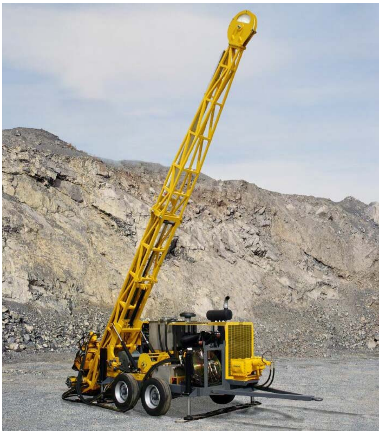
Рисунок 3.3 Внешний вид установки колонкового бурения Christensen CS-14
